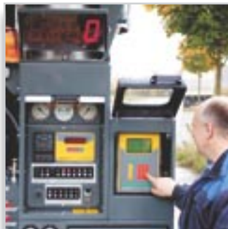
LKW-Leitstand mit Eingabe, Waage und Grossanzeige
